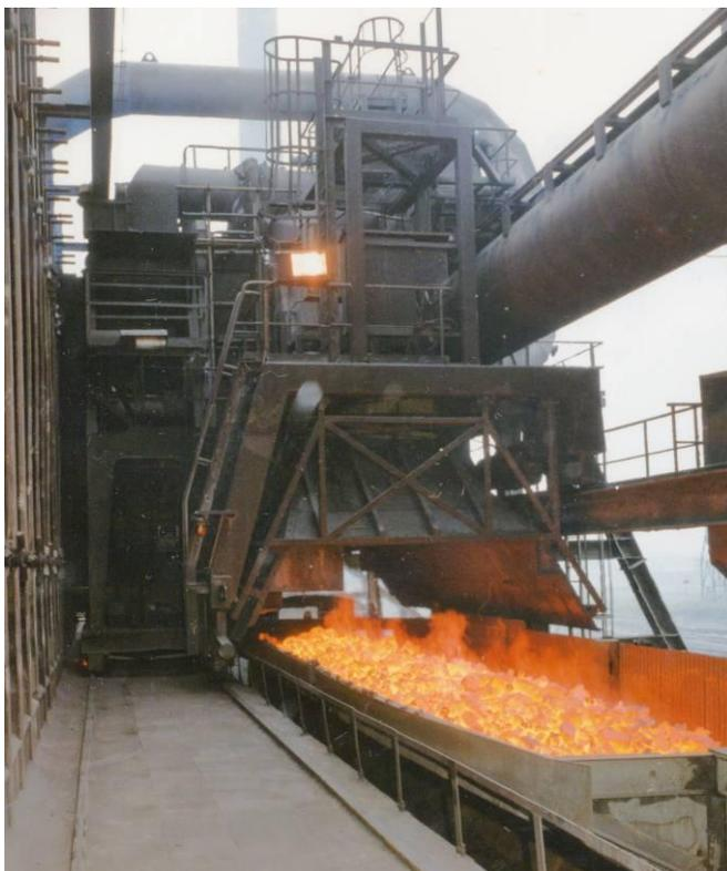
Abb. 37: Kokerei Gneisenau, 1989. Der KKF-Wagen ist um eine Haubenentstaubung erweitert worden.
